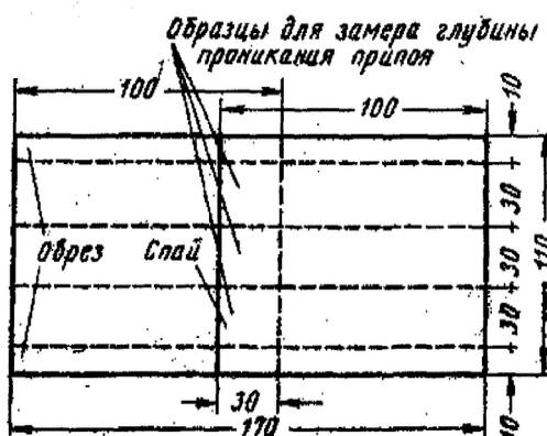
Рисунок 8.2 - Вырезка образцов для замера глубины проникновения припоя
