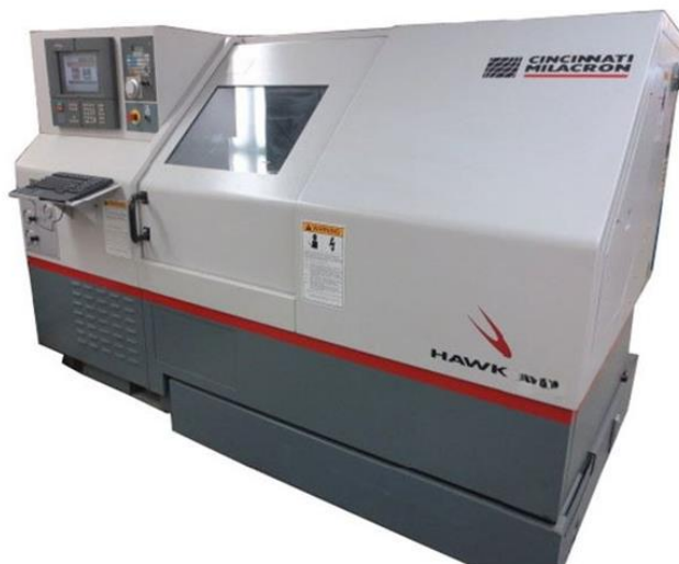
Токарный станок с ЧПУ Cincinnati HAWK-250
